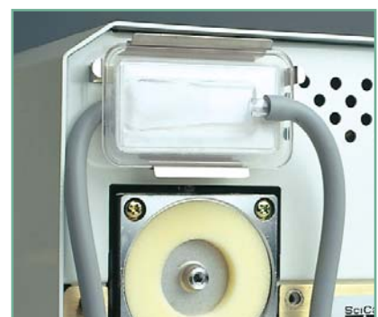
Wichtig ist ein biologischer Filter, der verhindert, dass Bakterien oder Sporen von mehr als 0,3 µm während der Trocknungsphase in die Sterilisationskammer gelangen. Die Filter des wirksamen Luftfiltersystems - sind leicht zugänglich und rasch austauschbar.
