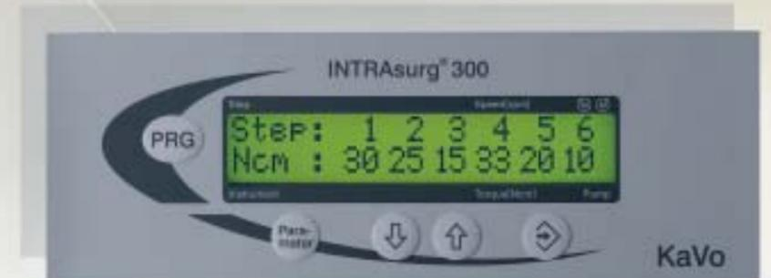
Programmende: Anzeige der maximalen Drehmomente zur Beurteilung der Primärstabilität.
