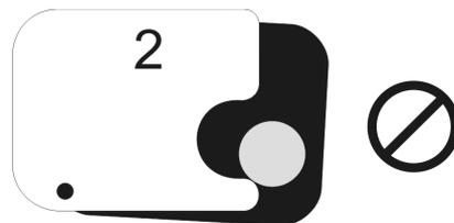
**HINWEIS!** Die Speicherfolie muss vollständig in der Schutzhülle stecken. Sie können die Speicherfolie mitsamt der Schutzhülle in den Plattenträger einsetzen. Das Gerät verarbeitet die Aufnahme erst dann, wenn die Schutzhülle entfernt wurde.
